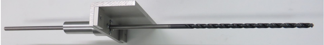
Langgatboormal 10 mm t.b.v. bekabeling deuren 566 7000
